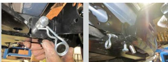
**ШАГ 5.** Зафиксируйте съемный шар болтом M10x20 снизу. Затяните съёмный шар с помощью ключа на 38 мм. Установка завершена.
