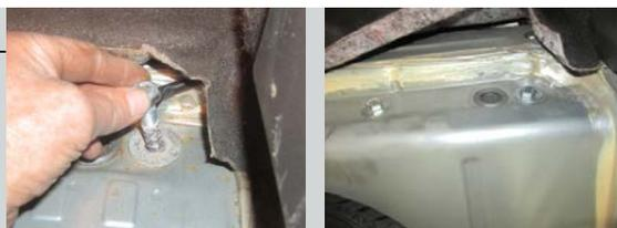
**ШАГ 2.** Перед установкой кронштейнов разместите закладные пластины как показано на фото. Установите кронштейны и закрепите их на болтах M12x110x1,25 с помощью гаек M12x1,25 через шайбы и гроверы как показано на схеме. Соединения не затягивать.
