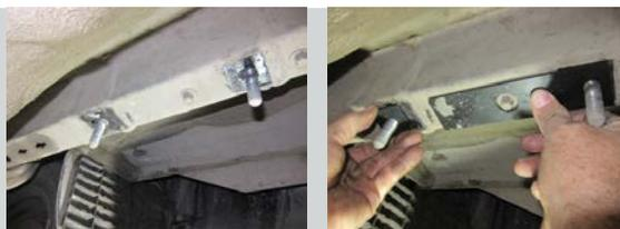
**ШАГ 3.** Установите центральный кронштейн совместив отверстия в боковых кронштейнах и в центральном. Закрепите кронштейн центральный с помощью болтов M10x30x1,25 через шайбы на 10 и гроверы на 10 гайками M10x1,25. Отрегулируйте положение центрального кронштейна и затяните все резьбовые соединения.
