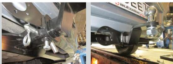
Тип соединения: шаровый; Диаметр сцепного шара: 50 мм.; Масса комплекта TCU 02041501: 16,2 кг.
