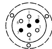
**Примечание.** На прицепах других производителей может использоваться контакт 5 для подключения габаритных огней и освещения номерного знака.
