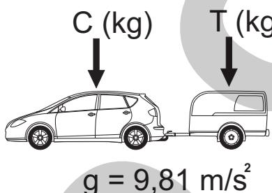
$$D \geq \frac{T \cdot C}{T+C} \cdot \frac{g}{1000} \text{ (kN)}$$
