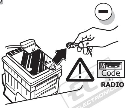
(DE) Um Störungen und Schäden am Bordnetz zu vermeiden, muss die Massepolklemme unbedingt vor Beginn aller Arbeiten von der Fahrzeugbatterie getrennt werden! Insbesondere bei Arbeiten und Anschlüssen am CAN-Datenbus kann bei nicht abgeklemmter Batterie sowohl das Anhängermodul als auch das fahrzeugsseitige Bordnetzsteuergerät beschädigt werden! Bitte Herstellervorschriften beim Ab- und Anklemmen der Fahrzeugbatterie beachten!
